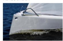
So etwas wie ein Markenzeichen von bluboats ist das Loch im Bug geworden. Es ersetzt einen herkömmlichen Bugbeschlag. Rumpf und Deck der blu26 werden komplett als Airex-Sandwich laminiert. Bemerkenswert sind Kiel und Ruder: Mit ganz angehobenem Kiel wird der Tiefgang zum Auswassern auf 0,5 m reduziert und das Ruder kann als komplette Einheit entfernt werden. Ein am Heck angehängtes Ruderblatt wäre im Handling einfacher, bei Match Races aber gefährlicher gewesen.
