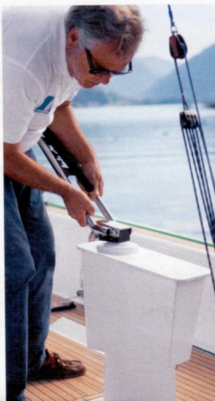
Sammlung aus Curryklemmen über dem Niedergang zusammen. Die Schotwünschen von Lewmar sind bewusst nicht selbstholend ausgestattet, bei Bedarf kann die Schot in einer Klemme unterhalb der Winde fixiert werden. Das funktioniert gut, es sollte aber ein Leitblech aufgesetzt werden, da sonst das Gelcoat schnell durchscheuern wird.
